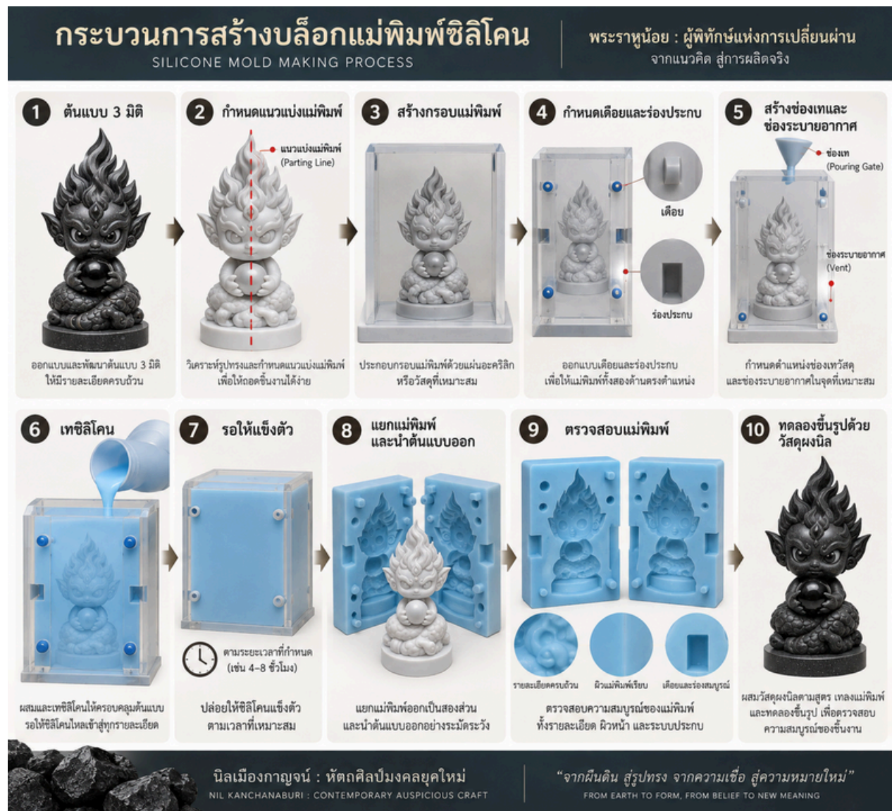
ภาพที่ 50 กระบวนการสร้างบล็อกแม่พิมพ์ซิลิโคนสำหรับ พระราหูน้อย : ผู้พิทักษ์แห่งการเปลี่ยนผ่าน
