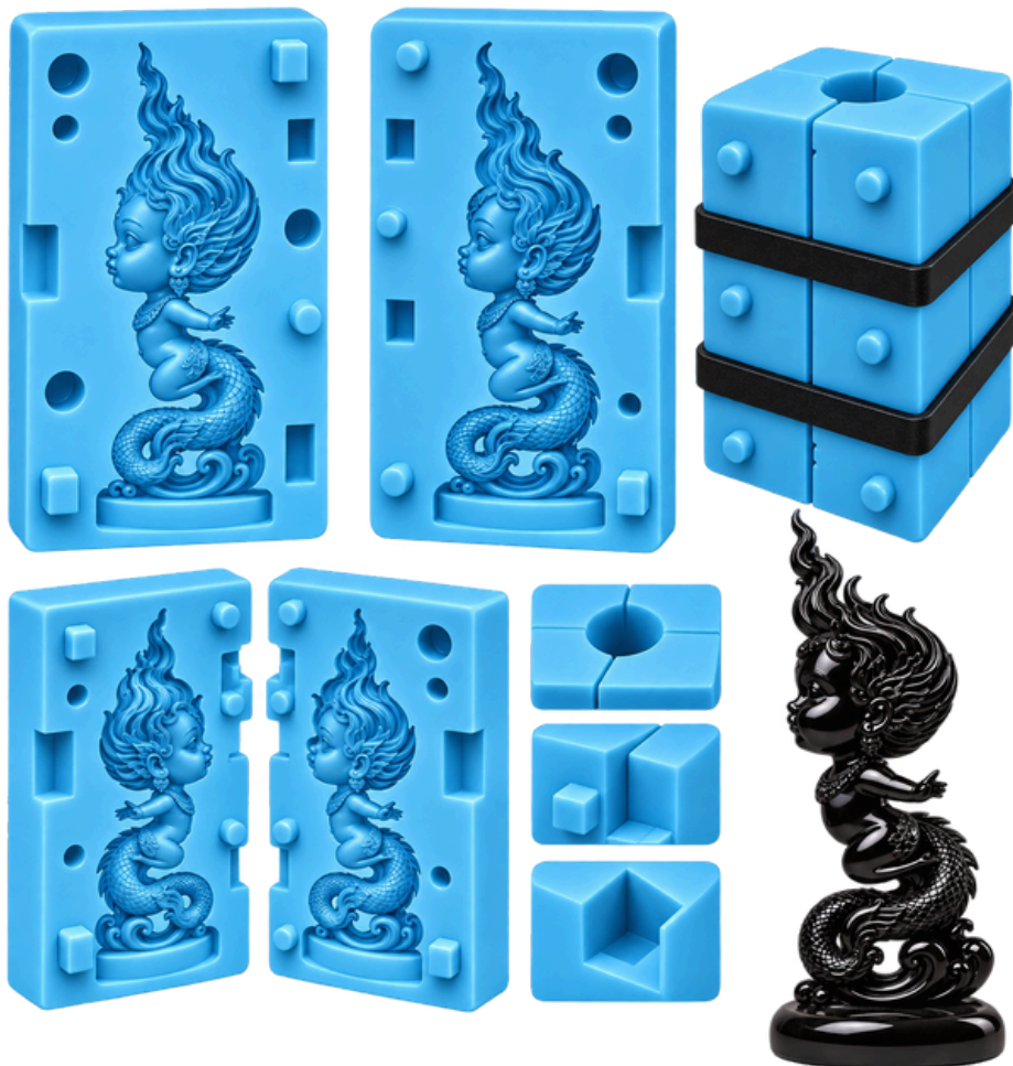
ภาพที่ 56 กระบวนการสร้างบล็อกแม่พิมพ์ซิลิโคนสำหรับ พระราหูน้อย : ผู้พิทักษ์แห่งการเปลี่ยนผ่าน
